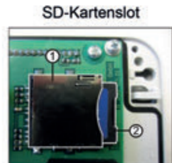
Programmierte Schaltzeiten können auf der internen SD-Karte gespeichert und im Bedarfsfall wieder ausgelesen werden.
